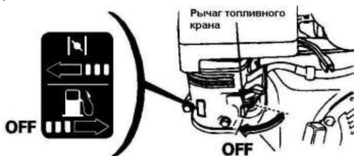
Рисунок 12 – Рычаг топливного крана в положении "OFF" ("Выключено")
