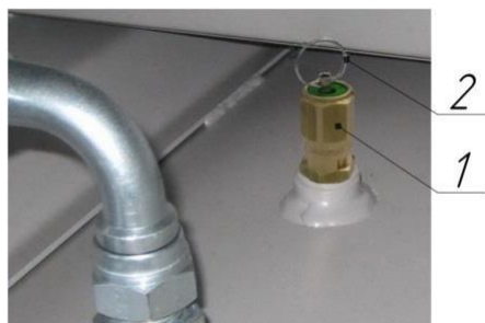
Рисунок 11 – Клапан предохранительный пружинного типа
