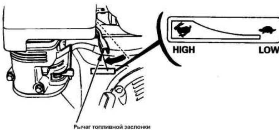
Рисунок 5 – Рычаг топливной заслонки
