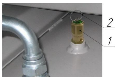
Рисунок 8 – Клапан предохранительный пружинного типа
